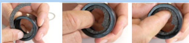
Figur 159: Ilægning af filtrering
